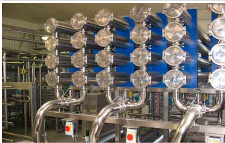
Auf Basis von UF Technologie kann die BMI nun Molkenpulver mit 80 % Eiweißgehalt herstellen (Foto: BMI)
