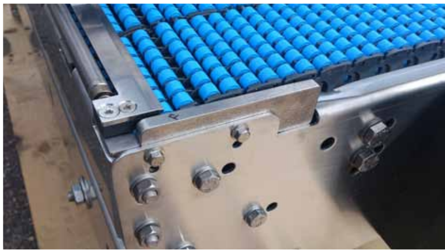
Mehr Arbeitssicherheit – Krones Safetec Röllchenmattenkette mit Eingriffschutz (Foto: Krones)
