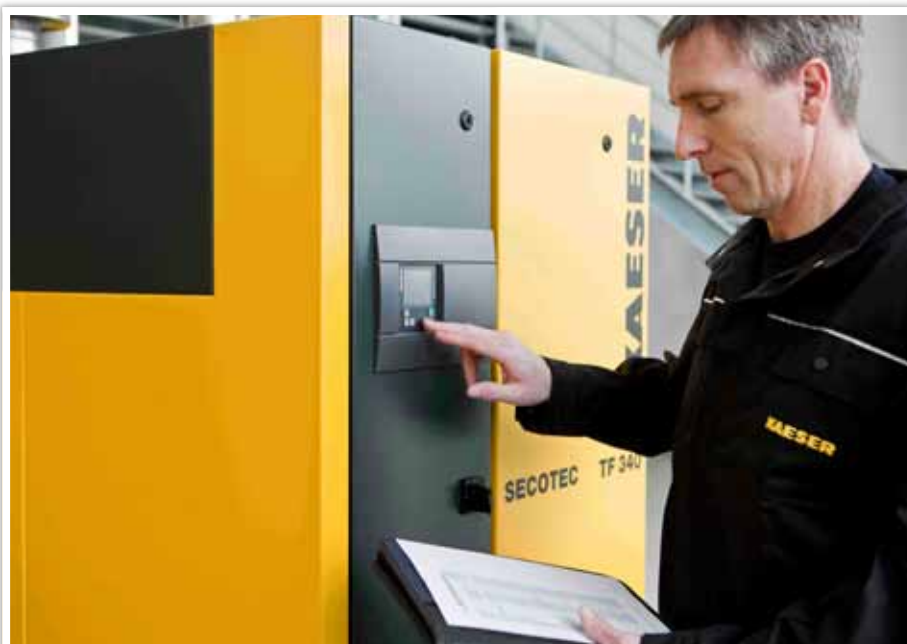
Die wirtschaftlichen Speicherkältetrockner der Baureihe Secotec sind nun bis zu einem Volumenstrom von 34 m 3 /min erhältlich (Foto: Kaeser)
