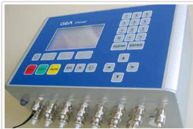
Datenerfassungssystem ZEVODAT-flash (Foto: GEA Diessel)
