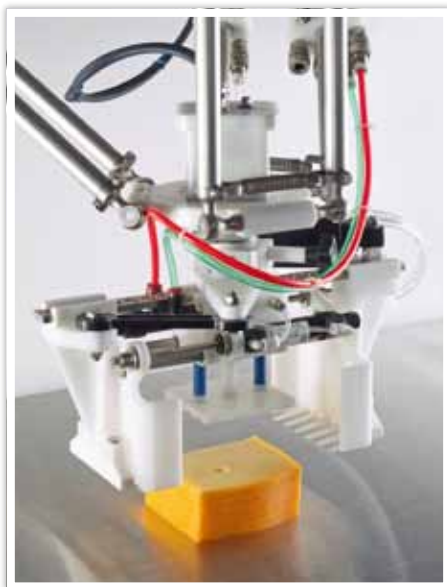
Produkte aller gängigen Portionsformen und -größen erkennt der Weber Pick Robot (WPR) durch sein integriertes Kameragehäuse automatisch (Foto: Weber Maschinenbau)
