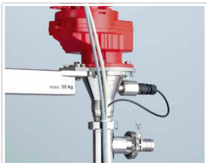
FLUX-GERÄTE stellte eine berührungslose Durchflussmessung vor (Foto: FLUX-GERÄTE)
