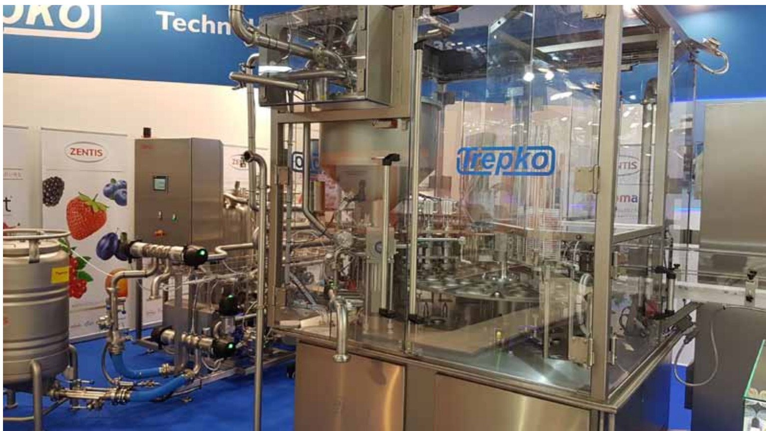
Trepro stellte den besonders bedienerfreundlichen Rundfüller 223-1 KS aus, der drei- und einbahnig arbeiten kann (Foto: mi)
