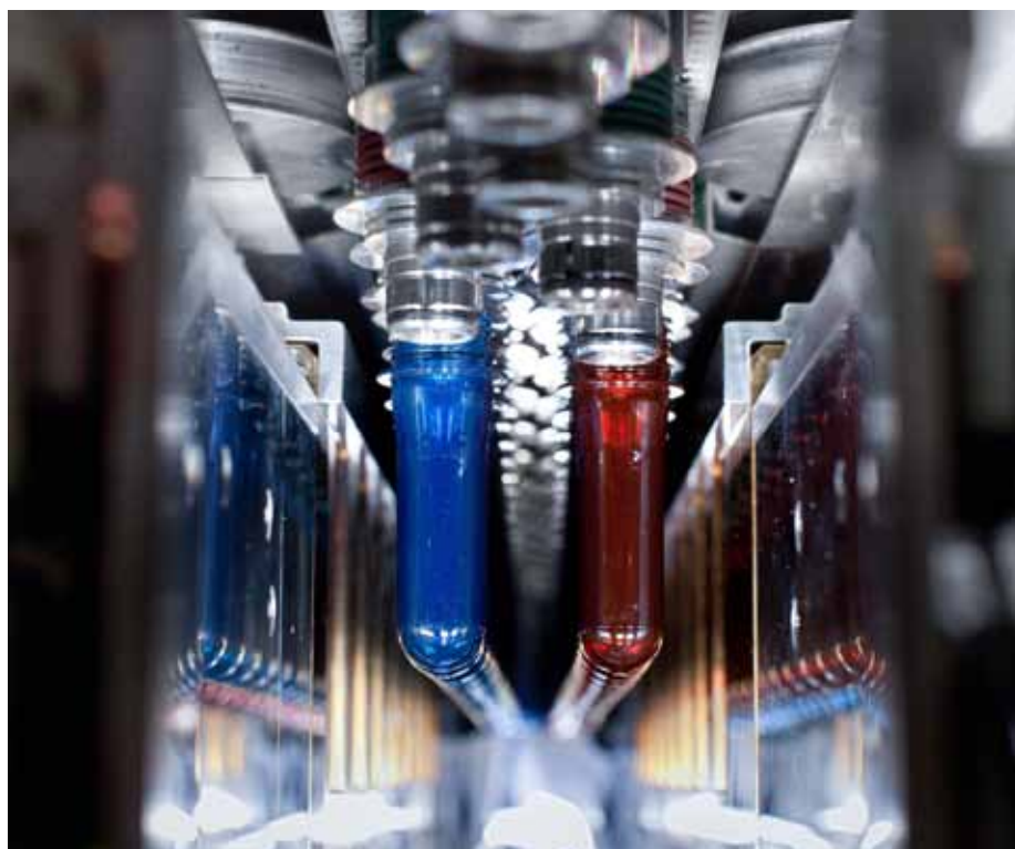
Die neue, von Sidel entwickelte, laserinduzierte Heizung bietet größere Freiheit für die Kunststoff-Flaschenform (Foto: Sidel)
