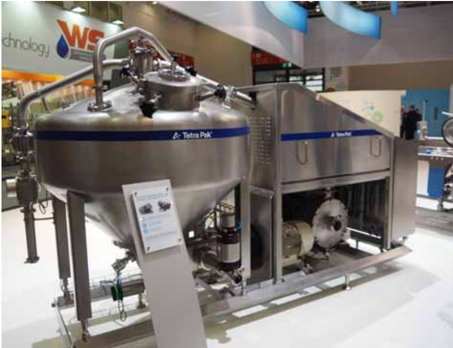
Die Tetra Pak Dispersieranlage R370-1000D spart Energie, Wasser und teure Zutaten wie Stabilisatoren ein (Foto: mi)
