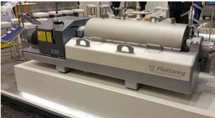
Der neue Flottweg-Dekanter Z2E ist hygienisch ausgelegt und kann 1 m 3 Molkenstaub/h auf 40 – 50% TS bringen (Foto: mi)
