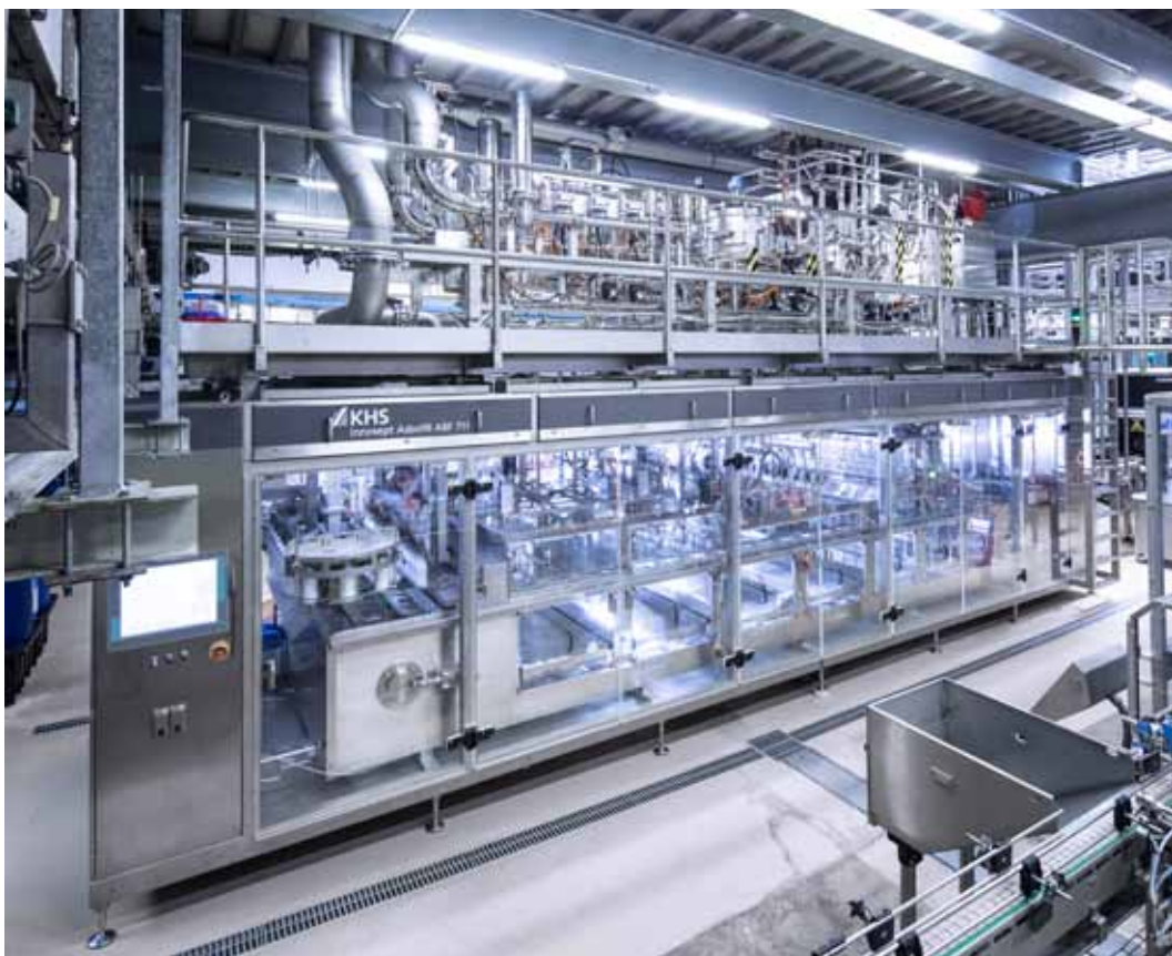
Die NÖM hat eine Innosept Asbofill ABF 711 zur Abfüllung von Milch und Milchmischgetränken in PET installiert (Foto: KHS)
