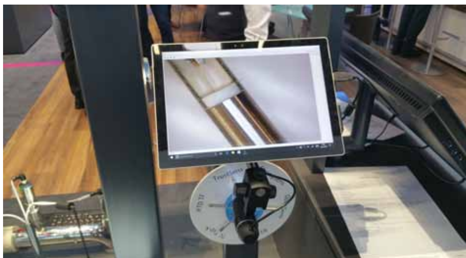
Mittels Kamera-Vergrößerung zeigte Endress+Hauser am Messestand den unterschiedlichen Aufbau von Temperatur-Sensoren, bei denen die eingebaute Referenz-Keramik zur Selbstkalibrierung von Widerstandsthermometern Thermoelementen über eine spezielle Keramik zu sehen war (Foto: mi)
