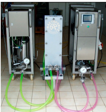
Abbildung 1: Angeschlossene Prüfstation mit zirkulierender Prüflösung
