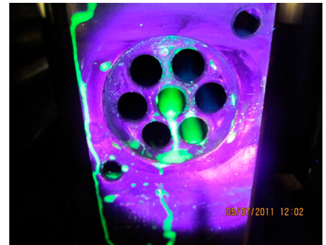
Abbildung 6: Lokalisierung des defekten Austauscherrohrs in einem Röhrenmodul, die mit grünem Prüfmittel gefluteten Röhren sind defekt. Prüfmittel gelangt vom Mantel in den produktführenden Bereich
